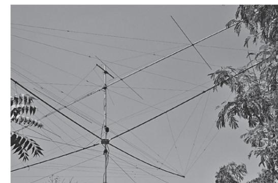
TT8SNの14~28MHz用スパイダー・ビームと50MHz用7エレメント八木宇田アンテナ
